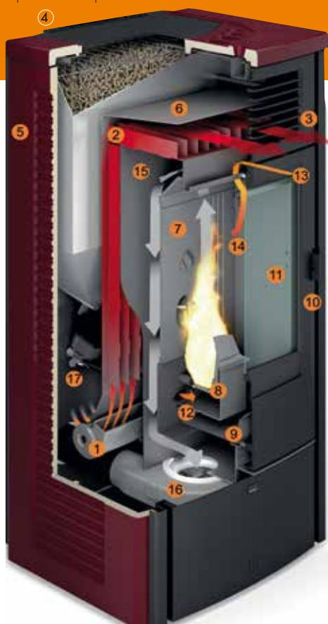
De gebruiksvriendelijke Superiorpelletkachels zijn niet enkel veilig, maar ook duurzaam. De stalen structuur en de gietijzeren vlamkeerplaat, brandkorf en deur staan garant voor een robuuste kachel met een lange levensduur.
