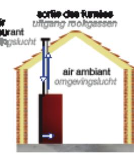
Fonctionnement avec air comburant pré-chauffé prélevé à l'extérieur de la pièce où le poêle est installé avec tuyau coaxial.
